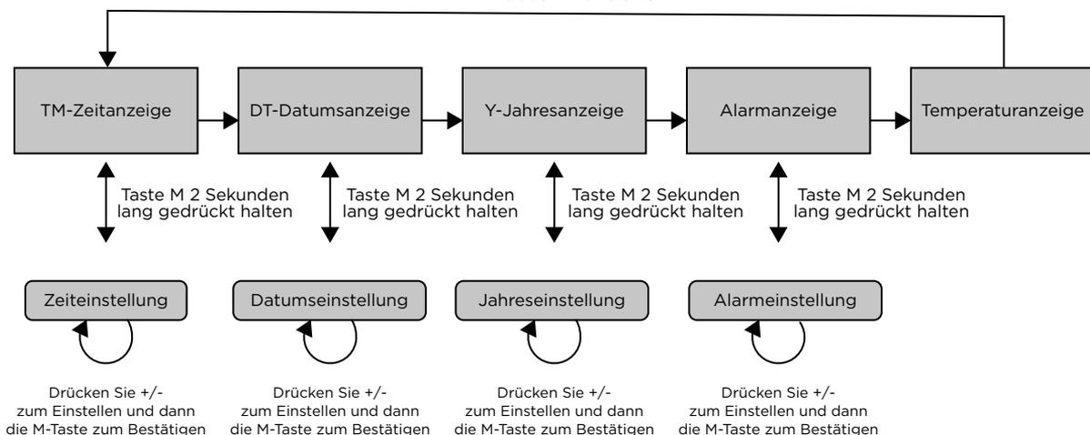
Drücken Sie die Taste +, um in einem anderen Anzeigemodus auf den Temperaturanzeigemodus umzuschalten, das Gerät schaltet nach 5 Sekunden automatisch in den vorherigen Anzeigemodus zurück.
